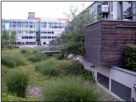
Die Bilder zeigen Beispiele für Mulden- / Rigolensysteme, die in bebauten Flächen integriert werden können und nicht nur ihre technische Funktion erfüllen, sondern darüber hinaus als Gestaltungselemente durchaus für eine Aufwertung des Quartiers sorgen können.
